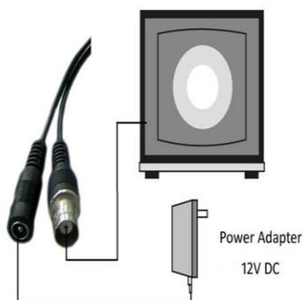
Рис. 5.1. Коммутация разъемов видеокамеры
